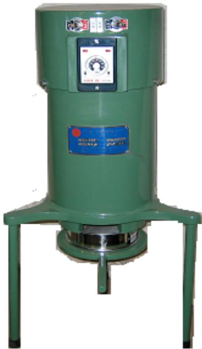
✓ 本機配合精密天秤適用於快速測定鑄物砂之水份含量。
