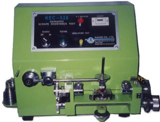
✓ 本機適用於測定 0.25 $\phi$ mm 以上漆膜導線之耐磨損性能。
