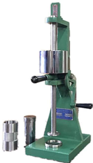
✓ 本機依據日本 NIK 所訂標準規範設計製造，專門製造鑄物砂標準試樣，配合鑄物砂強度、透氣性、安定性、硬度及壓縮比裝置等設備測定鑄物砂特性。
