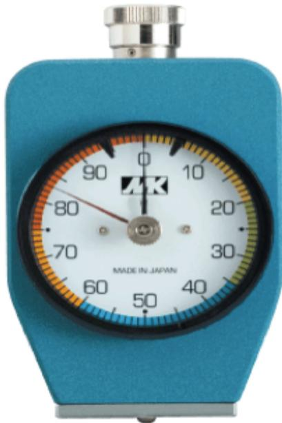
✓ 本機適於測定鑄物砂模之硬度。
