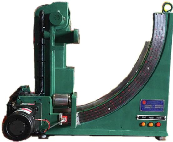
✓ 本機依據日本 NIK 所訂標準規範設計製造，配合搗樣機，適用於一般鑄物砂測定低抗拉、抗壓、抗剪強度。
