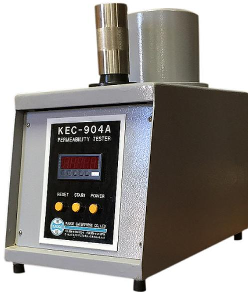
✓ 本機為氣壓式機組，依據日本 NIK, 美國 AFS 規範標準設計製造，以氣壓缸驅動，LED 精確顯示鑄物砂之水柱透氣量。
