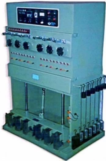
✓ 本機依據 UL - 817 標準規範設計製造，適用於測定各類規範之插頭線導片結合度，地線之絕緣度及絕緣外皮之包覆強度。
