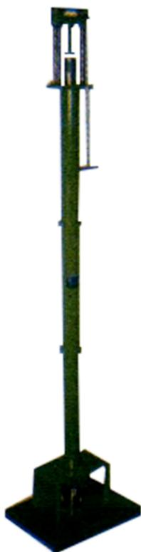
✓ 本機依據 APS 及 DIN 標準規範設計製造，配合精密天秤，適用於鑄物砂模以跌落衝擊方式規定砂模之結合。
