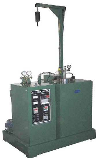
✓ 本機依據三菱靜岡法規範標準設計製造，適用於焙製冷凍壓縮機之漆膜導線試樣，經耐冷媒性劣化處理後，再製作 JIS、IEC、NEMA 規範之各種檢測試樣，與未經裂化前之數據比較。
