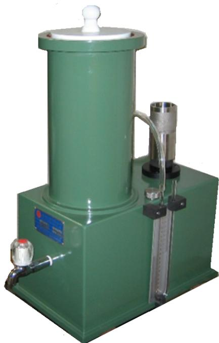
✓ 本機依據日本 NIK 所訂標準規範設計製造，適用於測定鑄物砂之透氣度。
