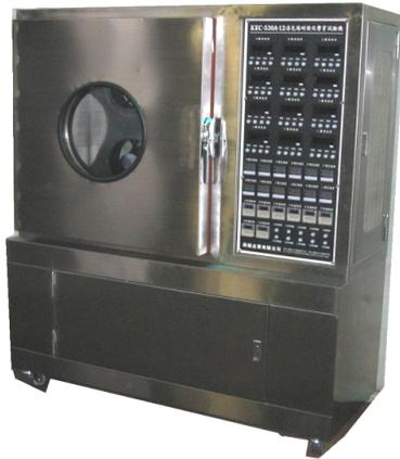
✓ 本機適用於漆膜導線(圓線.平角線)在熱狀態下以昇溫式.定溫式交叉法測定漆膜工件的耐軟化性能。
